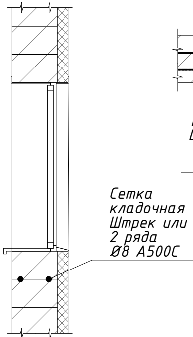
Узел армирования стен под окнами
